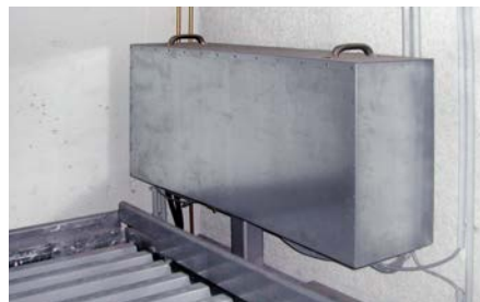
Schallschutzhaube für das Aggregat
